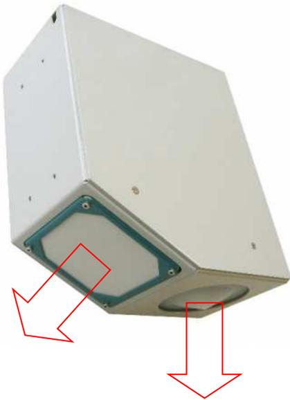
RQ-30 は従来の静止面しか捉えられなかった電波式や超音波式の水辺計や、確度の低い電波式流速計と異なり、24 GHz のレーダー領域の電波を利用して素早く動く面を正確に捉えます。また従来の超音波式水辺計のように温度等の気象条件に影響されることなく、堅牢にして省電力型の、かつ設置条件を選ばない、長期間メンテナンス・フリーの計測器です。非接触型なので洪水時にセンサーが濁流に流される心配もありません。
